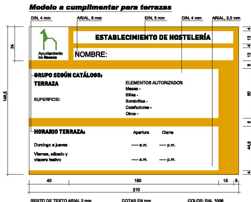
La placa podrá ser de aluminio o latón de 210 mm. x 148,5 mm. Y 1 mm. de espesor, con el texto grabado en edificios protegidos o en aquellos en los que voluntariamente el propietario así lo desee. Se sujetará mediante dos tornillos avellanados de acero inoxidable, para el anclaje de la placa al paramento.
