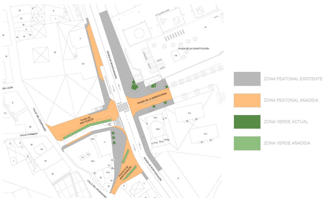
Ilustración 27. Diseño funcional orientativo para la mejora del espacio peatonal en el entorno del colegio San Vicente. Fuente: DOYMO.
