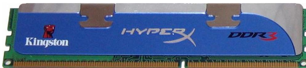
Estos módulos pueden transferir datos a una tasa de reloj efectiva de 800-1600 MHz, comparado con el rango actual del DDR2 de 533-800 MHz ó 200-400 MHz del DDR. Se prevé que la tecnología DDR3 sea dos veces más rápida que la DDR2, la memoria mayor velocidad hoy en día, y el alto ancho de banda que prometió ofrecer DDR3 es la mejor para la combinación de un sistema dual y procesadores "quad core".
